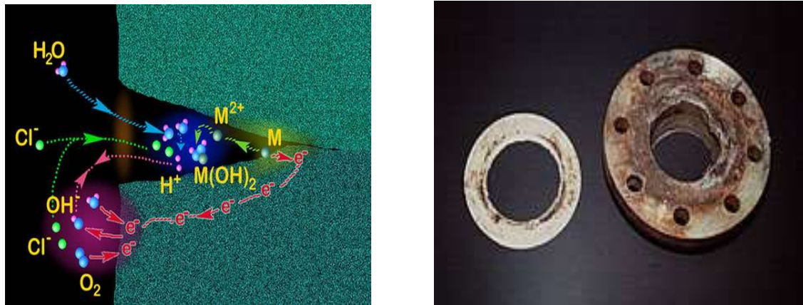
Figure II.7 Corrosion cavernouse d'un acier allié sous un joint.
