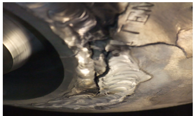
Figure III.12 corrosion au niveau de Hand Holes
