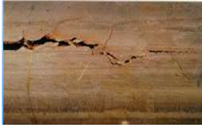
Figure II.11 Corrosion sous contrainte d'un tube inox en présence des chlorures
