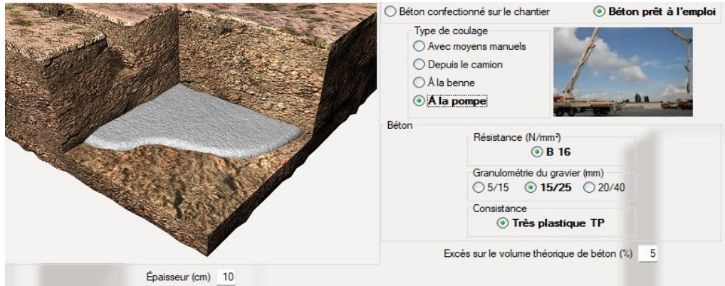
Figure 72: béton de propreté
