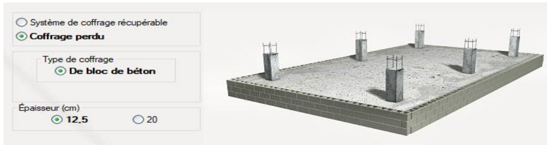
Figure 75: coffrage pour le radier Finition pour le radier
