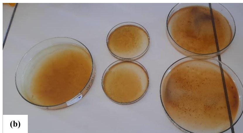
Figure16 : Séchage des extraits à l'étuve. Aperçu avant séchage (a) et après séchage (b).
