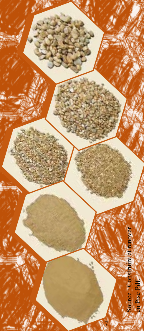
Figure 3 : Granulométrie d'une terre à pisé
