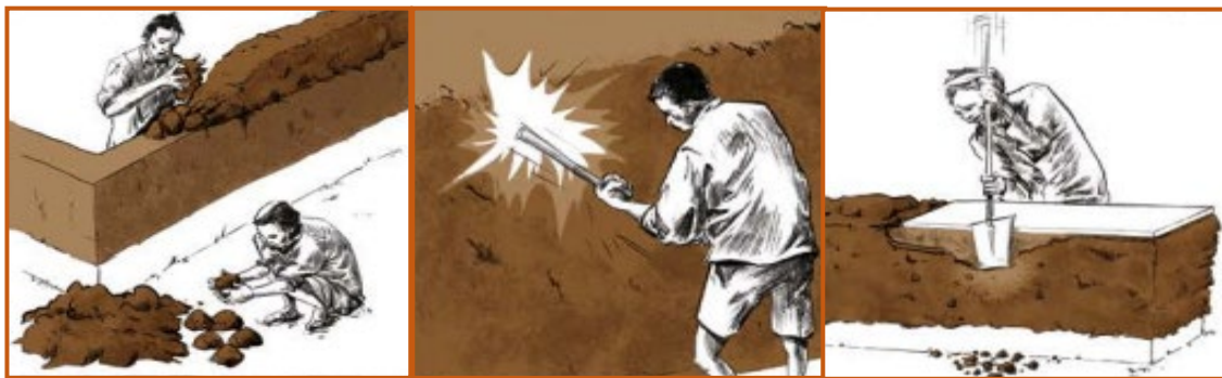
Figure 21 : Les étapes de construction en Bauge.
