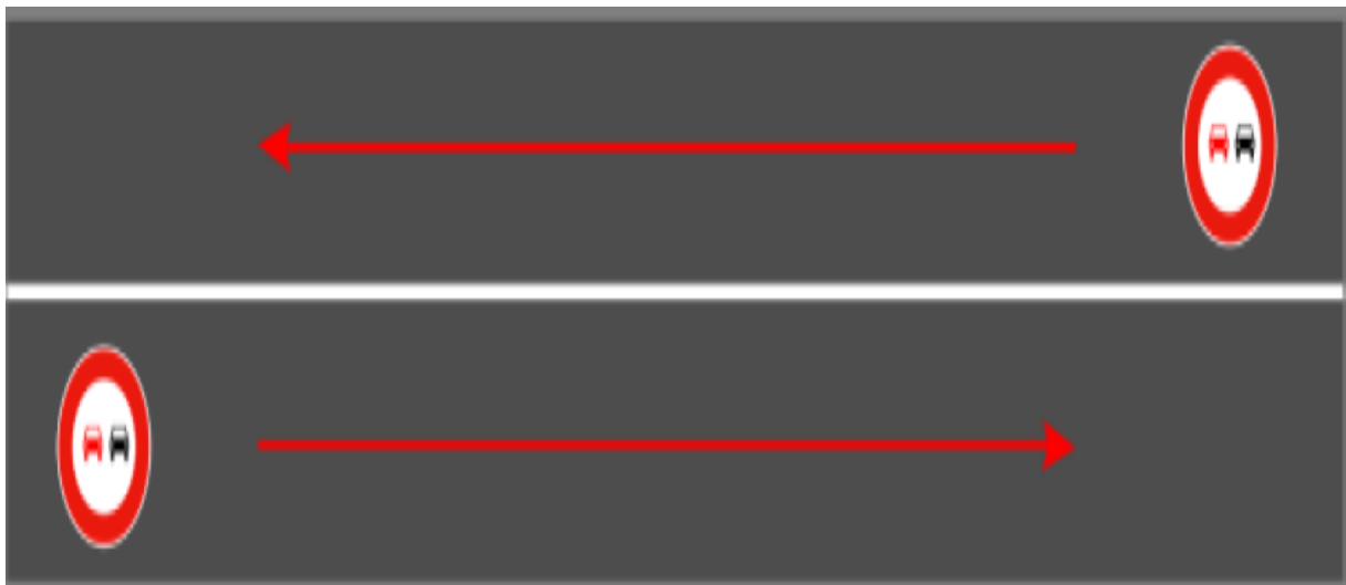
Figure 23 : Ligne continue interdisant le franchissement ou le chevauchement
