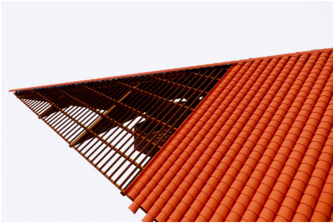
Figure 92 : Vue de la charpente avec couverture incomplète : moitié des tuiles posées.
