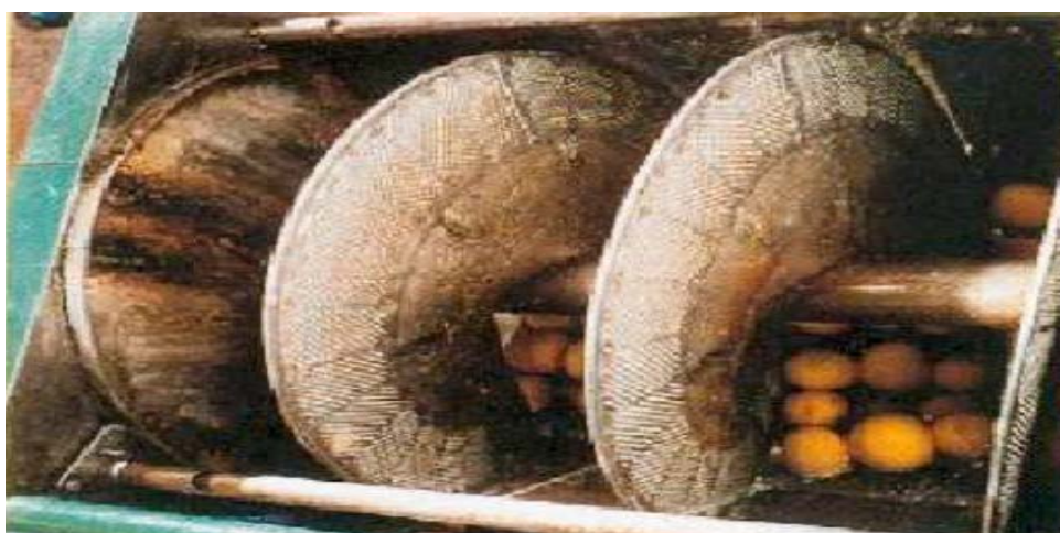
Fig. 13 – Extraction par expression à froid (Beneteaud, 2011)
