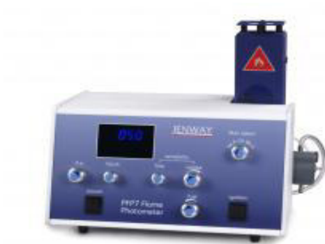
Figure n° 13 : spectrophotomètre à flamme marque Jenway.
