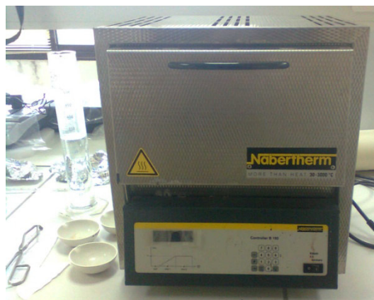
Figure n° 12 : four à moufle marque Nabertherm.
