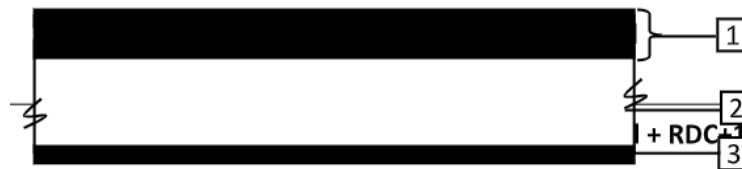
Fig. II.7: Coupe transversale de la dalle pleine
