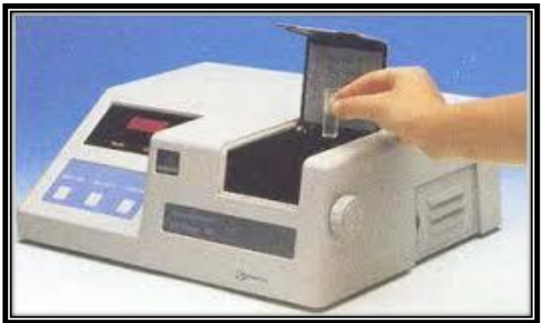
Figure IV.2 Schéma d'un spectrophotomètre HACH DR /4000 U.
