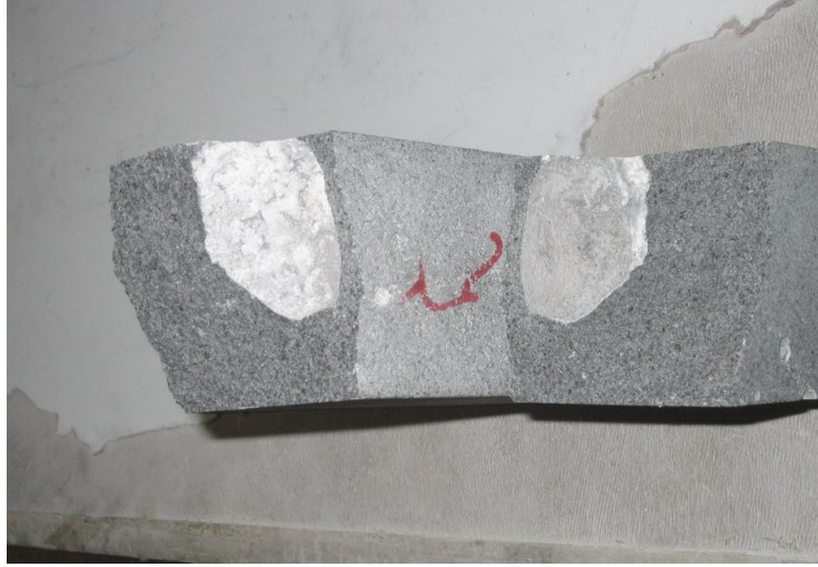
صورة رقم (4-16). تبين العيب الموجود في العينة المكسورة على الانعطاف
