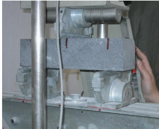
صورة رقم (4-15). تبين توضع عينة الحجر في جهاز اختبار الانعطاف
