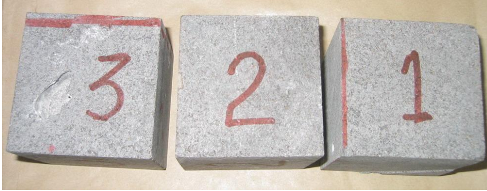
صورة رقم (4-1): تبين عينات من حجر بازلتي - جسر قم غرز - درعا
