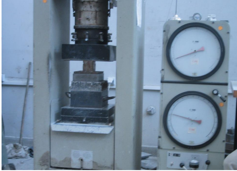
صورة رقم (4-17). تبين توضع العينة المكسورة على الضغط
