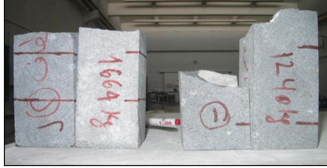
صورة رقم (4-2): تبين عينات بازلت مكسورة على الانعطاف
