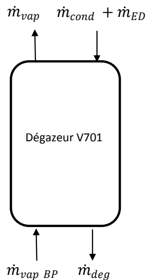
Figure III.1 : courants traversant le dégazeur
