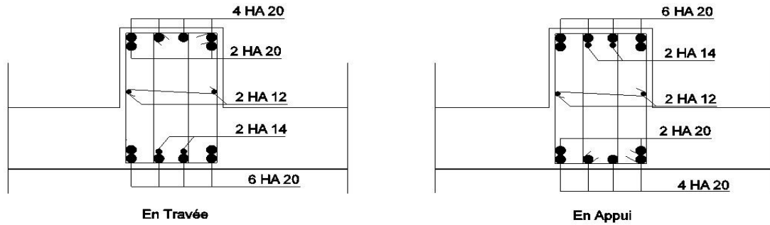
الشكل 10: تسليح الروافد الأرضية.
