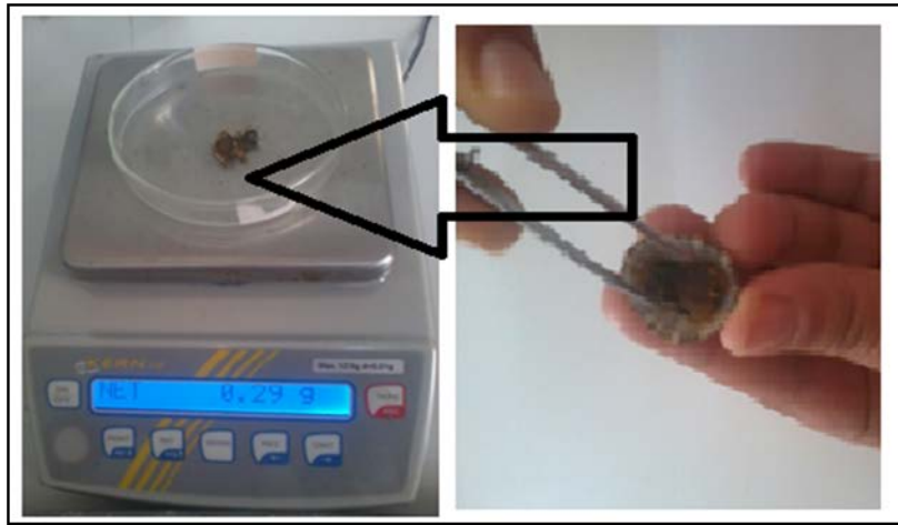
Figure 11: Pesée du poids sec de la chaire de la patelle sur la balance à précision. (Zbala&Benmaghni, 2017).
