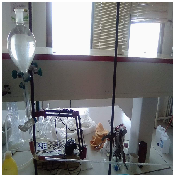
Figure16. Viscosimètre adapté à la mesure de la viscosité des laits fermentés.
