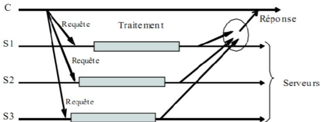
Figure 2.5 - Exemple de protocole de réplication active. [9]
