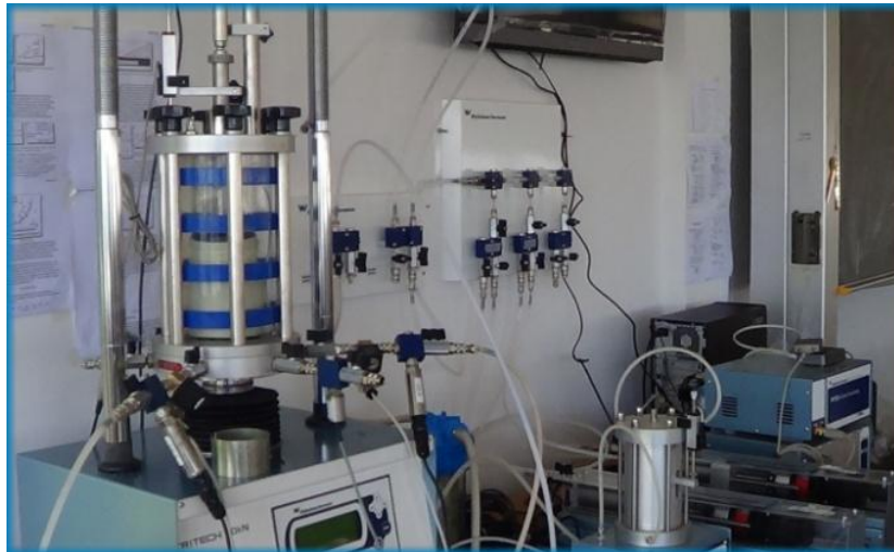
Figure 3.5 Appareil triaxial automatique 29-WF4632 utilisé
