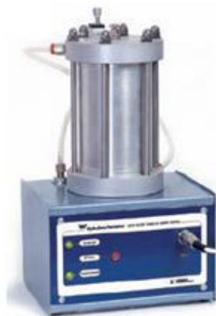
Figure 3.11 Appareil automatique de mesure de changement de volume
