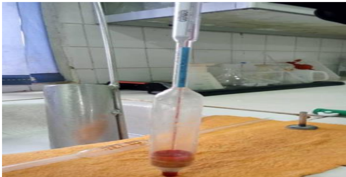
Figure 4. UN thermo –lactodensimètre(originale 2025)
