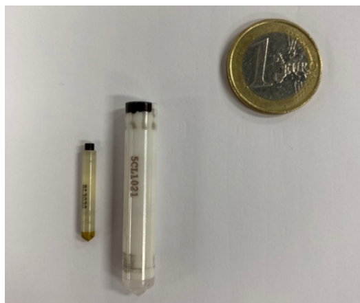
Figure 31: Rotors en \text{ZrO}_2 de 3,2 mm comparé aux rotors de 7,5 mm (utilisé pour Si) et à une pièce de 1 €
