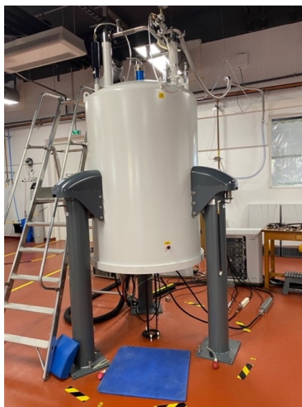
Figure 26: Spectromètre de Résonance Magnétique Nucléaire en rotation à l'angle magique (RMN-MAS) utilisé pour l'étude du ^{27}\text{Al} et du ^{31}\text{P}
