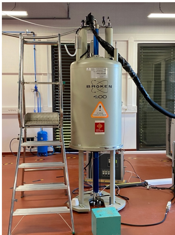
Figure 30: Spectromètre RMN en rotation à l'angle magique (RMN-MAS) utilisé pour l'étude du ^{29}\text{Si}
