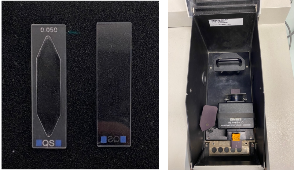
(b) Figure 10: (a) Spectromètre de réflexion diffuse UV-Visible, (b) porte échantillon en quartz,
