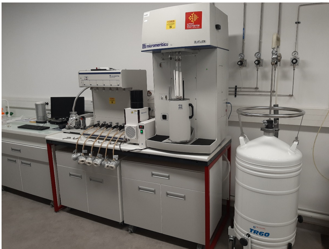
Figure 7: Dispositif de l'analyse de physisorption d'azote à l'ICGM
