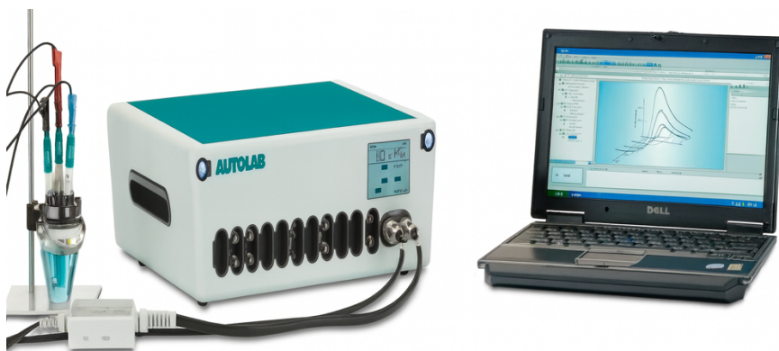
Figure 39: Montage expérimental utilisé pour les mesures électrochimiques
