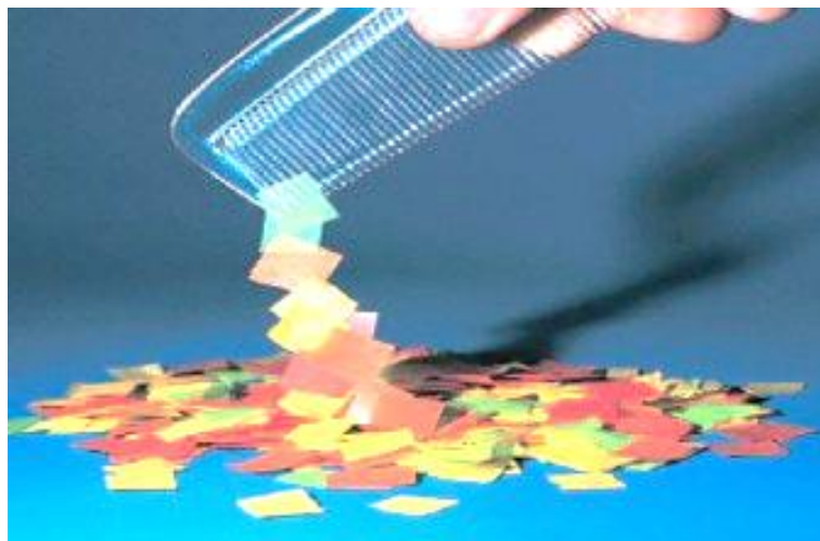
Fig.1.1. Le peigne frotté avec les cheveux attire les petits morceaux de papier
