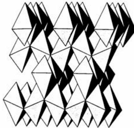
Figure. II.6. Structure cristallographique de l'anatase [92]
