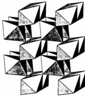
Figure. II.5. Structure cristallographique du rutile [92]
