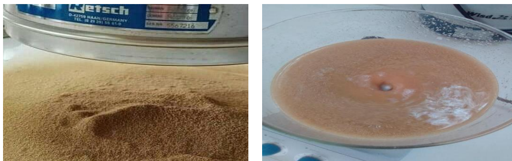
Figure IV.20 : processus Lavage et Tamisage.
