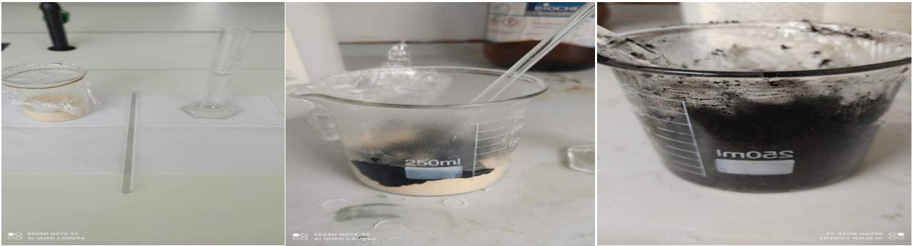
Figure IV.31 : processus d'activation avec l'acide sulfurique (H 2 SO 4 ) concentré 96%.
