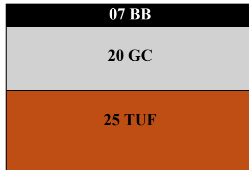
FIGURE.X. 2:Les couches de corps de chaussée.
