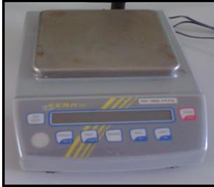
Figure 15 : Balance de précision de type DENVER INSTRUMENT M-220D (précision 0.01g) utilisée lors de notre étude.
