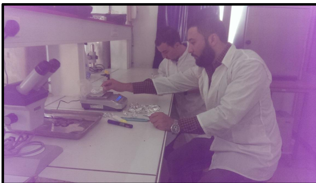
Figure 19 : Pesée des échantillons après passage au four à moufle.
