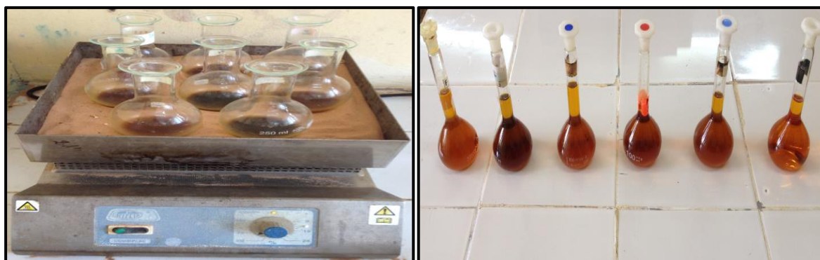
Figure 15. Attaque au froid sur le bain de sable. Figure 16. Séparation des phases.
