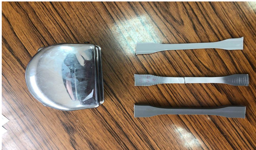
Figure III.14. Eprouvette après l'essai de traction.
