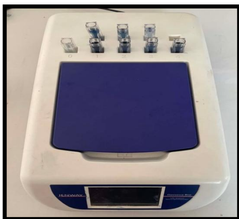
Figure 23: Mesure de l'absorbance des échantillons à l'aide d'un spectrophotomètre. (Photos réel).
