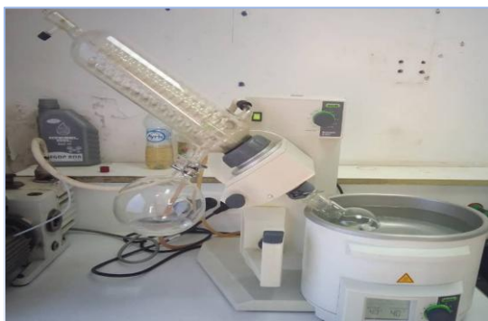
Figure 25: Évaporateur rotatif et ballons (Photos réel).
