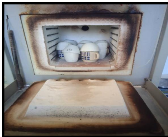
Figure 22: four à moufle (Photo réel)
