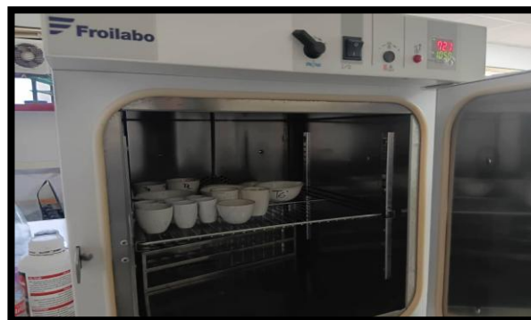
Figure 20: Creusets plus la matière sèche dans L'étuve (photos réelle).
