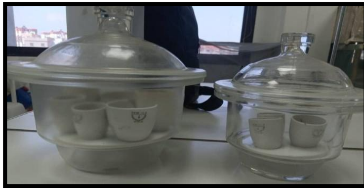
Figure 21: dessiccateur pour l'humidité (Photos réel
