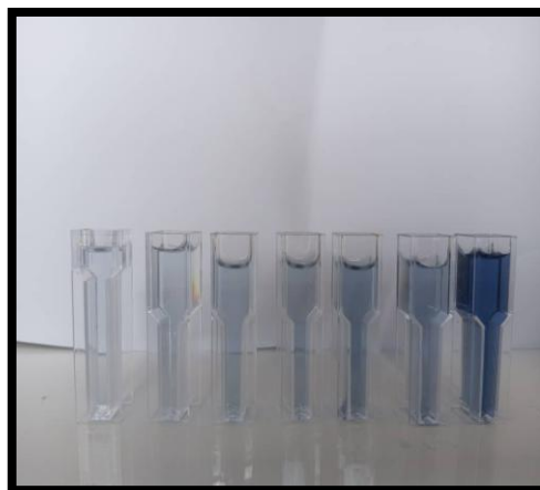
Figure 23: Mesure de l'absorbance des échantillons à l'aide d'un spectrophotomètre. (Photos réel).
