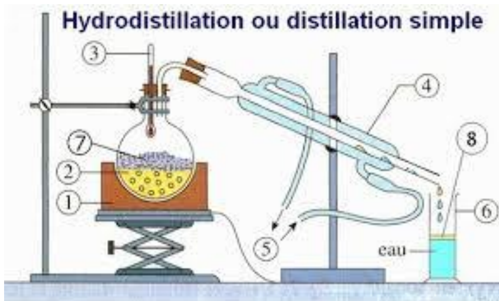
Figure 1 : Schéma du principe de technique d'hydrodistillation (LUCCHIESI, 2005).
