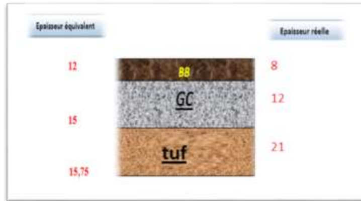
FIGURE 27 : LA STRUCTURE DE CHAUSSEE I
