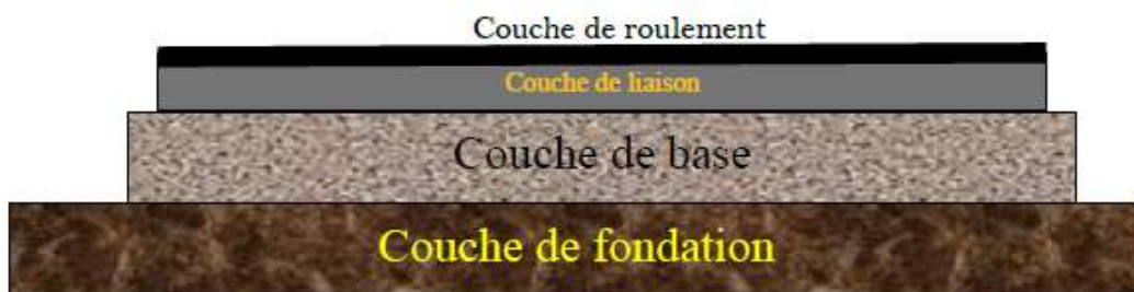
FIGURE 14 : COUPE TYPE D'UNE CHAUSSEE SOUPLE
