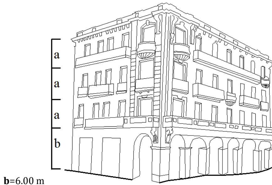
Figure 79 : Hauteur de la façade l'immeuble d'habitation
