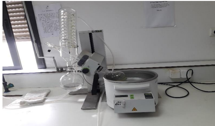
Figure16: image d'un rotavapeur (pour l'évaporation du solvant utilisé).
