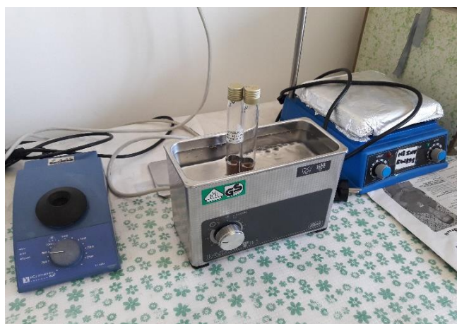
Figure 19: image représente un sonicateur.
