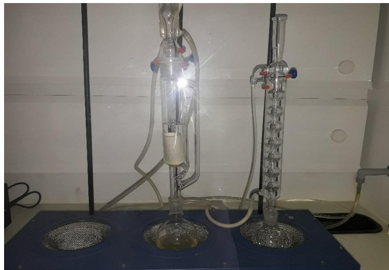
Figure15: Image représentative du soxhlet.
