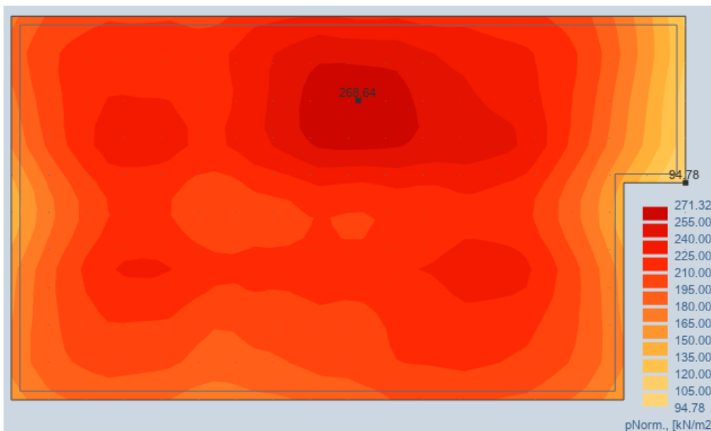
Fig VIII 6 : Cartographie de la distribution des contraintes à ELU.
