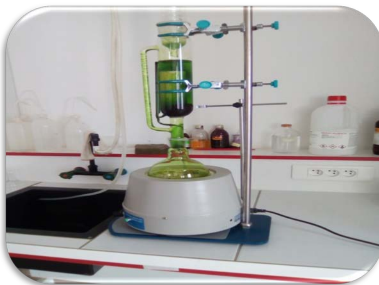
Figure 13: Le retour du solvant contenant les principes actifs de l'extracteur vers le ballon (Originale, 2017)
