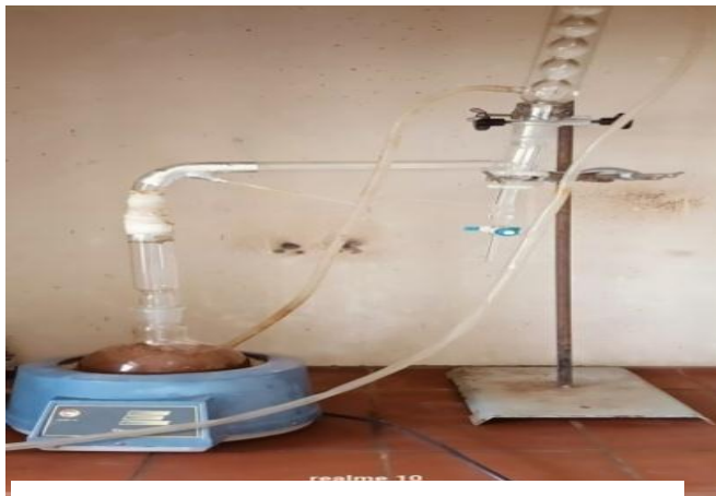
Figure II-2: Photographie du dispositif utilisé pour l'extraction des HE par Clevenger
