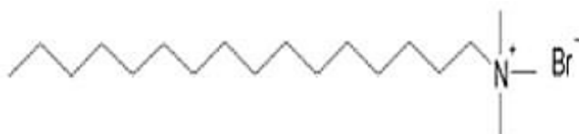
Schéma.6 Exemple de tensioactif cationique-le bromure decéyltriméthylammonium.
