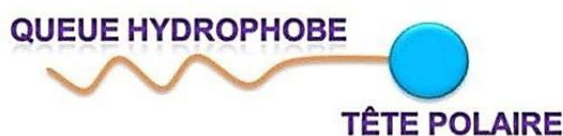
Schéma.4. Représentation schématique d'une molécule de tensioactif
