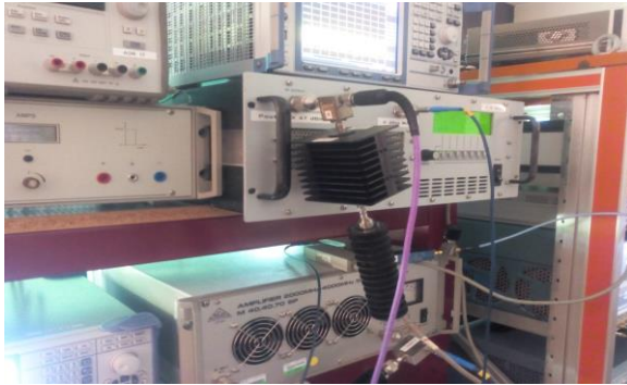
Chaîne d'amplification linéaire d'entrée
