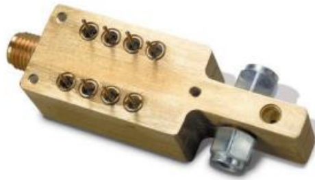
Figure II. 49 : Tête d'échantillonnage de PSPL 100 GHz
