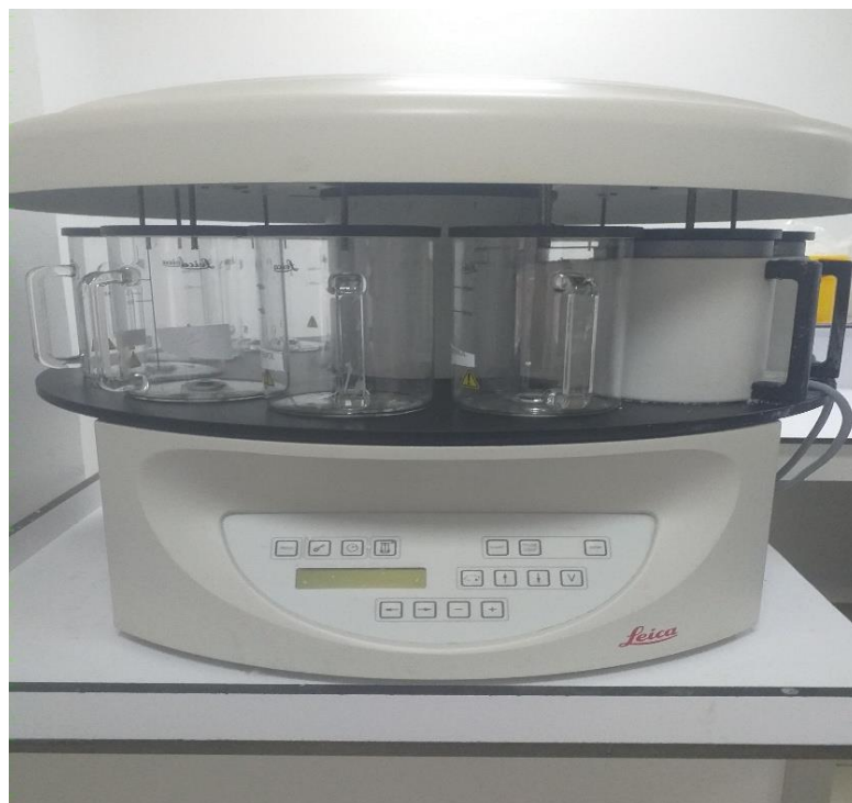
Figure23:Automate de traitement des tissus (processeur histologique)
