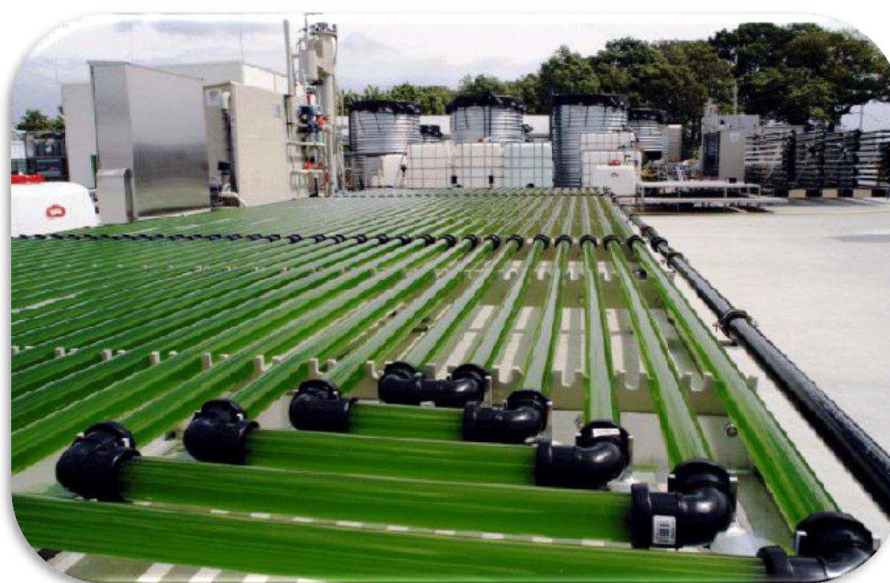
Figure 8. Photobioréacteurs tubulaires de l'université de Wageningen Algae Parc (Vian et al. , 2013).
