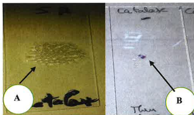
Figure 33 : observation macroscopique de la réaction à la catalase ; A : test (+) de l'échantillon (LTM) ; B : test (-) de l'échantillon (mur).
