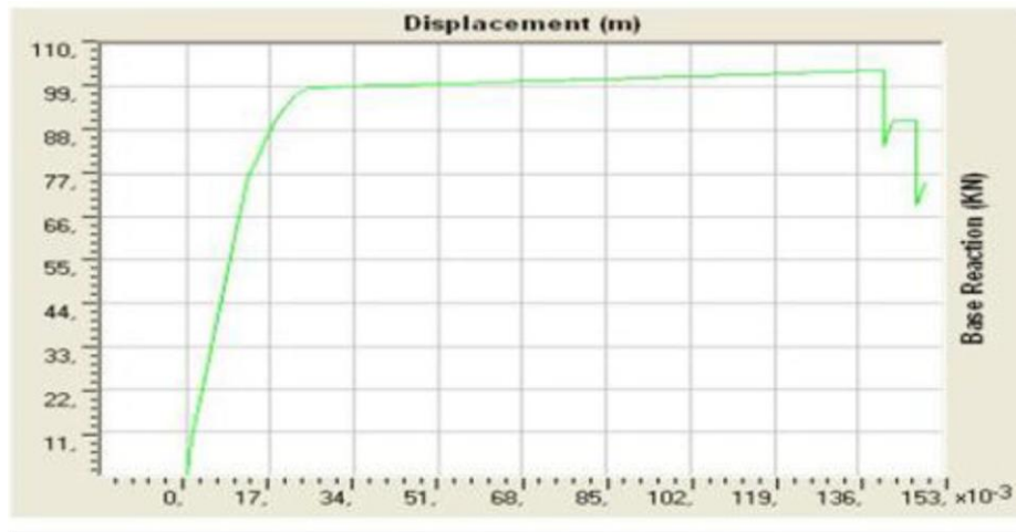
Figure 11 : : Courbe de capacité (pushover).
