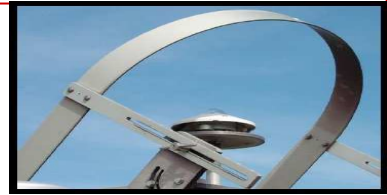
مقياس إشعاع الشمس المباشر (البيرايومتر): جهاز لقياس الإشعاع الشمسي المباشر
