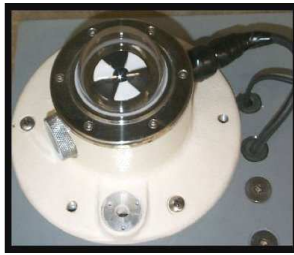
مقياس إشعاع الشمس (بيرايومتر): جهاز لقياس الإشعاع الشمسي الشمولي
