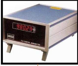
بارومتر دجتال (Digital) يقيس الضغط الجوي و يظهر القياس مباشرة على لوحة
