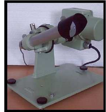
مقياس إشعاع الشمس المباشر (البيرايومتر): جهاز لقياس الإشعاع الشمسي المباشر
