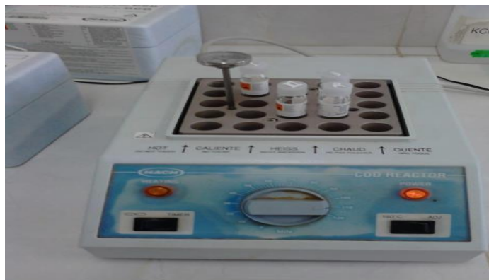
Figure 8 : Le réacteur DCO.
