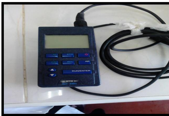
Figure 9: Appareil pour mesurer l'O 2 dissous.
