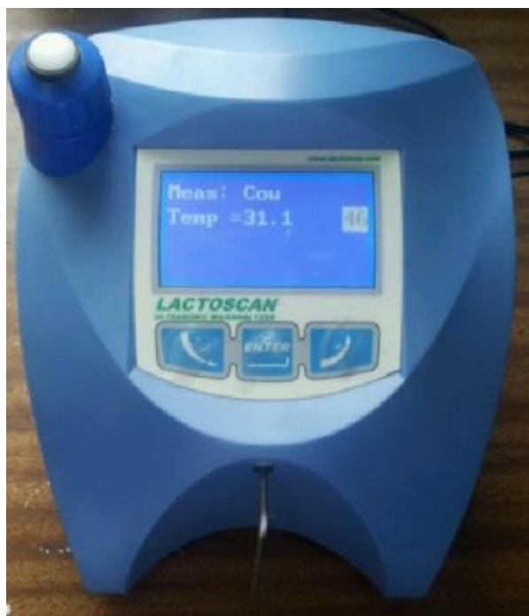
Figure 18. Appareil Lactoscan SP destiné à l'évaluation rapide des paramètres du lait (Benkrizi, N., 2019)
