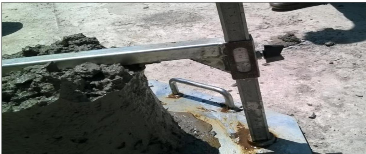
Figure 3.1 : L'affaissement d'un béton témoin.
