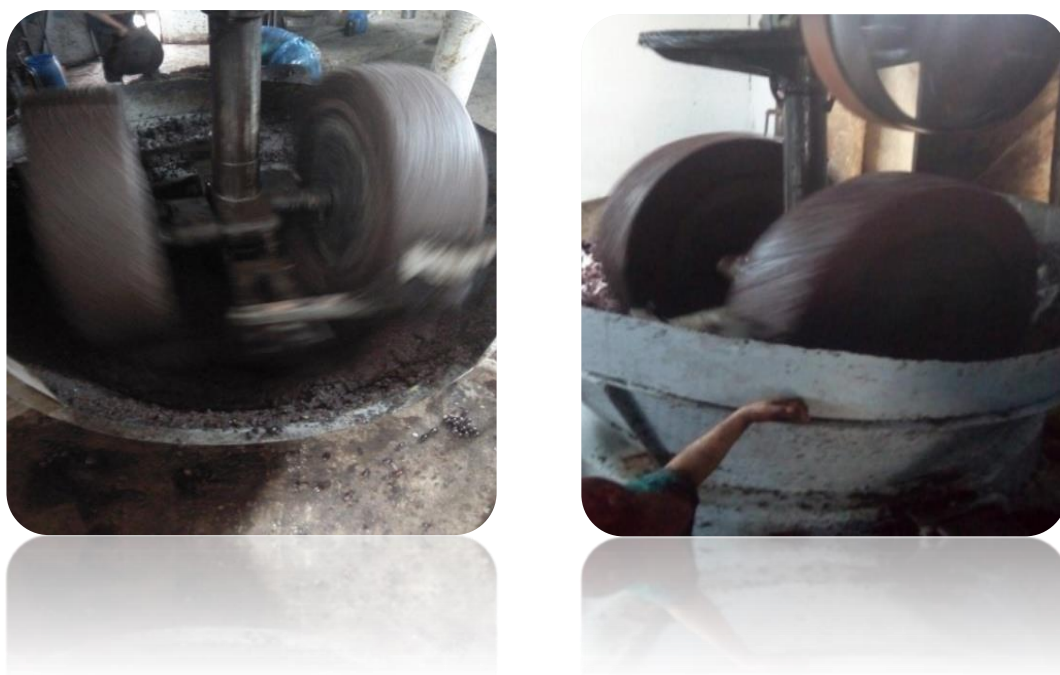
Figure19: Le malaxage des olives (Meridji Rabah 2020, Sidi Idir –Bejaia )
