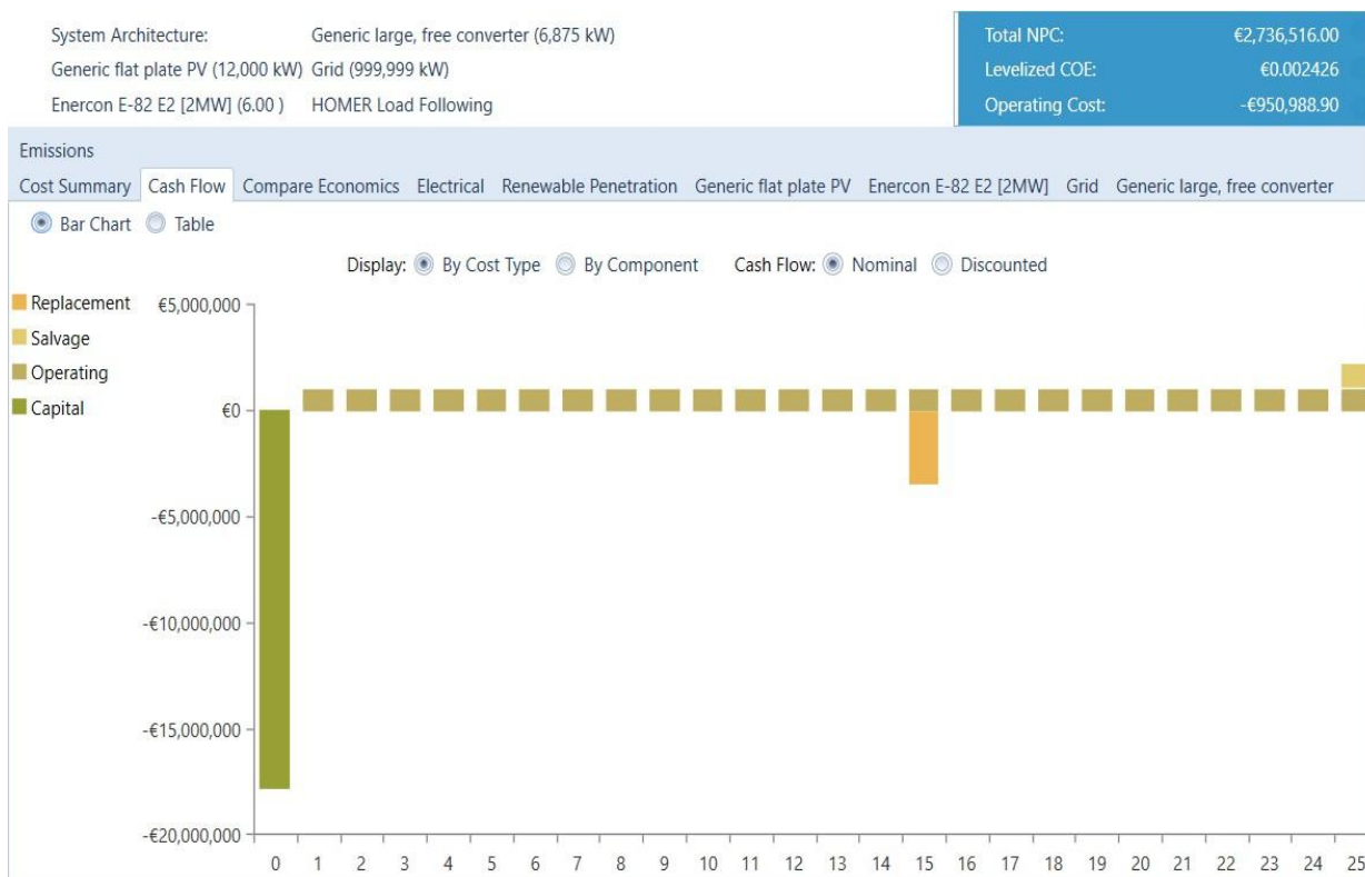
Figure (III.21) : Résumé des opérations et des remplacements pendant toute la durée de fonctionnement du système. La figure (III. 21) montre qu'avec notre système, les coûts de maintenance sont faible et que seul l'onduleur sera remplacé suite à sa durée de vie. De même le coût d'investissement initial est assez élevé mais le coût d'exploitation du système est faible durant les vingt-cinq ans du projet, permettant ainsi l'accumulation de presque 25000 $ soit 250000000de centime de dinar Algérien, chaque année pendant les vingt-quatre premières années.
