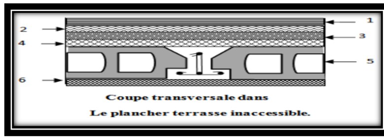
Figure II.2. Coupe transversale dans le plancher terrasse inaccessible.
