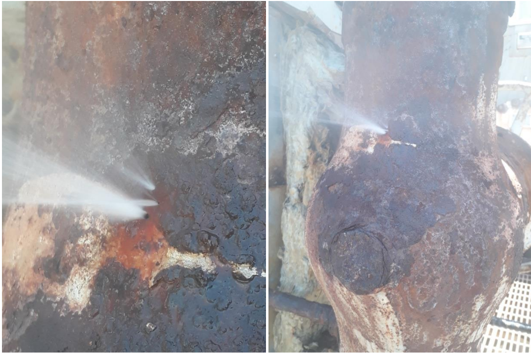
Figure III.2 : Effet d'une corrosion par piquûre.
