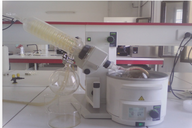
Figure12 : l'évaporateur rotatif BUCHE R-210 (Originale, 2017).
