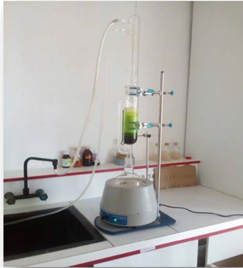
Figure 11: extraction hydro-alcoolique par dispositif Soxhlet. (Originale 2017).
