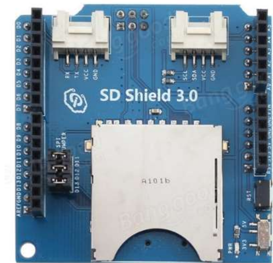
Figure 3. 28 : Vue de haut SD Shield
